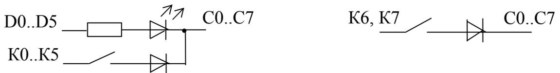
Рис. 1. Структурная схема матрицы контактов и индикации
