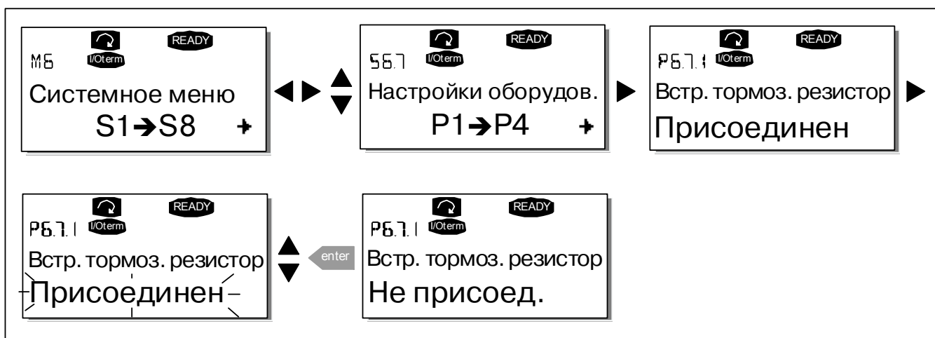
Рисунок 7-21. Подключение встроенного тормозного резистора
