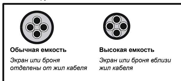
Рис. 7-2 Конструкция кабеля влияет на его емкость
