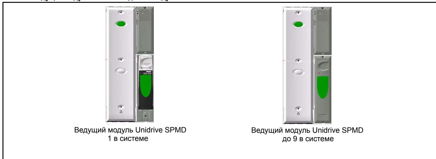
Рис 2-2 Ведущий модуль SPMD и ведомые модули
