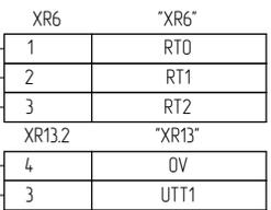
Подключение датчика(ов) температуры двигателя главного привода
